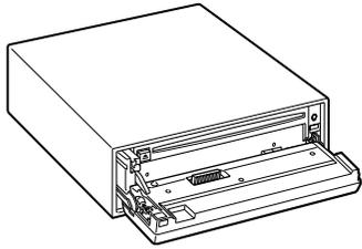
3 Прикрутите шуруп (диаметр 2 мм, длина 5 мм) (принадлежность (5)) и скобу (принадлежность (6)) к отверстию, как показано на рисунке.
