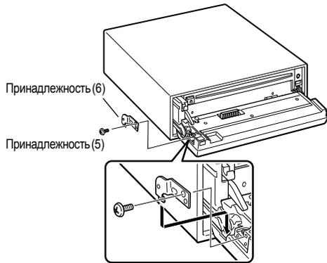
4 Прикрутите шуруп (диаметр 2 мм, длина 5 мм) (принадлежность (5)) и скобу (принадлежность (7)) к отверстию, как показано на рисунке.
