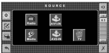
Нажмите кнопку на экране, соответствующую, необходимому Вам режиму: **Radio** (радиоприемник), **Media** (проигрыватель), **AV1-IN** (аудиовход 1), **AV2-IN** (аудиовход 2) и **TV** (ТВ приемник).
