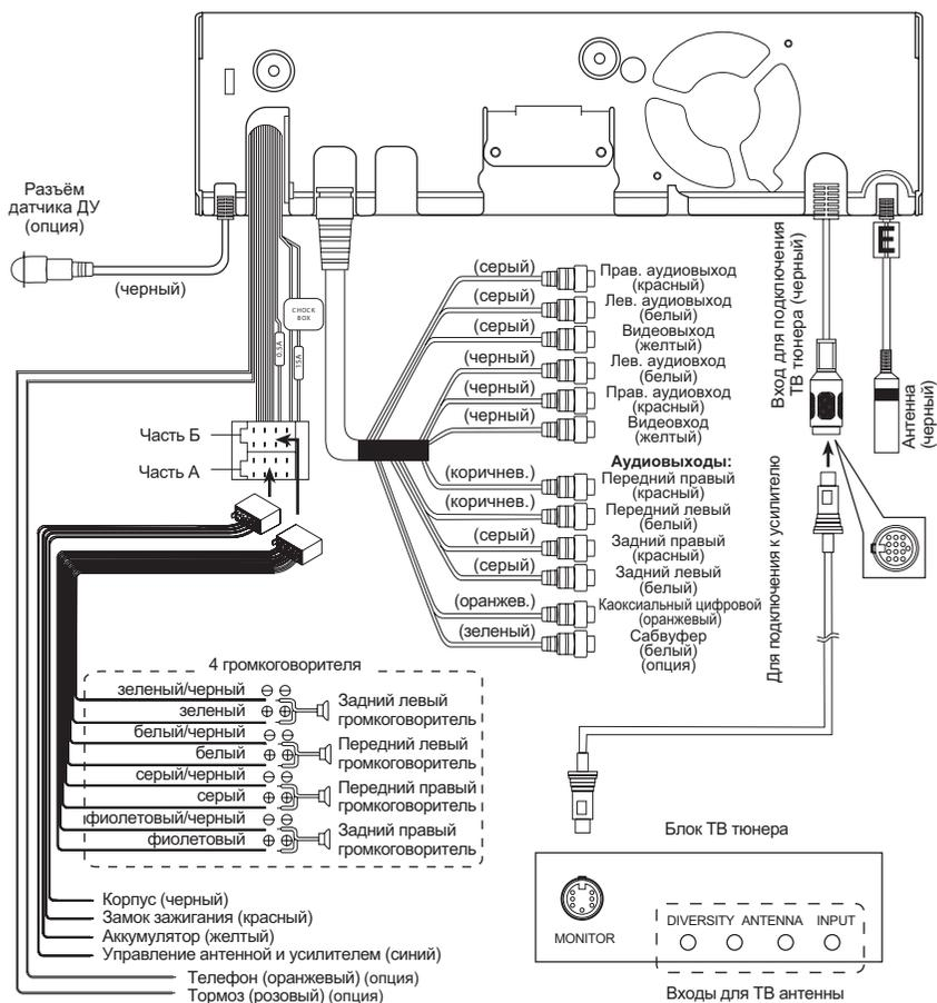
ТВ тюнер центра рассчитан на подключение антенны с штекером  $\varnothing 3,5$  мм.
