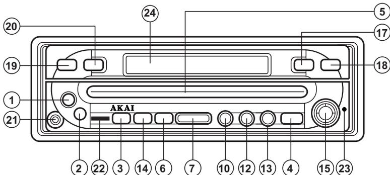
**ЛИЦЕВАЯ ПАНЕЛЬ ПРИ ВЫДВИНУТОМ МОНИТОРЕ**
