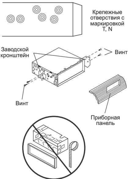
Закрепите центр в автомобиле с помощью специальных кронштейнов, скоб и винтов размером 5 x 5 мм или винтов с потайной головкой размером 4 x 5 мм (в зависимости от отверстий в кронштейнах).
