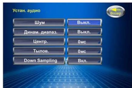
**Шум:** при помощи встроенного генератора шумов отрегулируйте уровень громкости сигнала каждого динамика.
