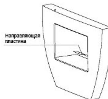
4. Зафиксируйте устройство в приборной панели с помощью специальных болтов в вашем автомобиле, затем наденьте рамку.
