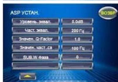
**Бас центр. част.:** выберите центральную частоту усиления низких частот: 40 Гц, 50 Гц, 60 Гц, 70 Гц, 80 Гц, 90 Гц, 100 Гц, 120 Гц, 150 Гц.
