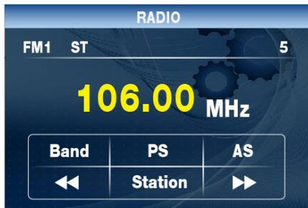
Последовательно нажимайте кнопку **BAND / SETUP** на передней панели, чтобы выбрать нужную функцию в экранном меню управления на дисплее: Band (Диапазон) -> PS (Сканирование) -> AS (Автопоиск) -> ◀ -> Station (Станция) -> ▶.
