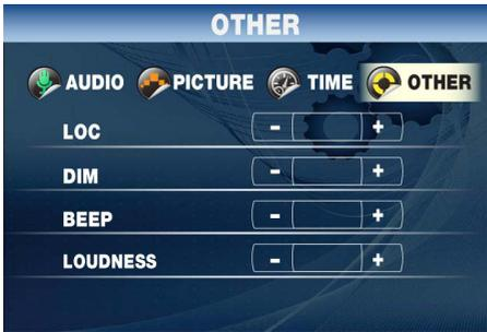
**LOC** – Настройка на прием радиостанций только с сильным сигналом в режиме автоматической настройки
