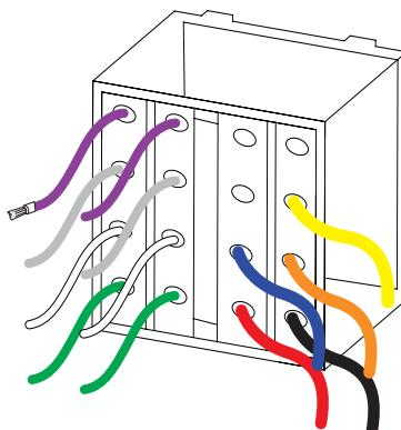
2 Внимательно проверьте кабели автомобиля, затем подключите их к стандартному разъему.
