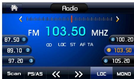
В верхней части экрана отображается шкала текущего диапазона
