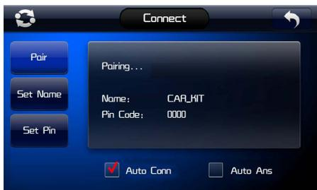
Чтобы установить соединение Bluetooth, коснитесь Pair (Соединение) на экране прибора, а затем также начните соединение Bluetooth на подключаемом устройстве.
