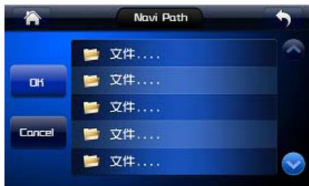
При первом запуске режима навигации необходимо установить путь к программе навигации в меню настроек, раздел NaviPath. Обычно нужный файл находится на SD карте с программой навигации в папке «Navitel», имеет расширение `__.exe` и называется «Navitel.exe».
