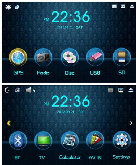
Коснитесь нужной иконки в главном меню аппарата, чтобы выбрать нужный режим: GPS, Radio, Disc, USB, SD, BT, TV, Calculator, AV IN, Settings.
