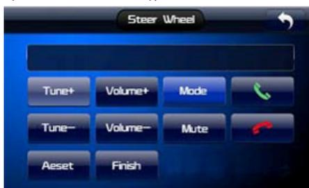
Нажмите кнопку на руле, затем коснитесь значка той функции, которую вы хотите закрепить за этой кнопкой. На дисплее должно отобразиться сообщение о том, что операция прошла успешно. Повторите то же для других кнопок. По окончании коснитесь значка Finish, чтобы сохранить настройки и выйти.
