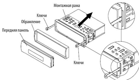
1. Вставьте до упора ключи, входящие в комплект поставки проигрывателя, в пазы на боковых поверхностях передней панели и извлеките проигрыватель из монтажной рамы.
