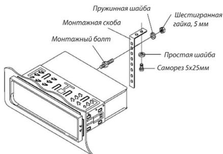
4. Закрепите заднюю часть устройства с помощью металлической скобы. Вы можете согнуть скобу руками. При монтаже убедитесь, что короткий резьбовой конец монтажного болта направлен к прибору, а длинный - к приборной панели.
