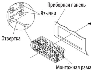
2. Установите монтажную раму (без проигрывателя)
