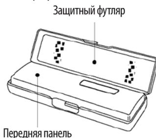
После снятия передней панели храните ее в защитном футляре.
