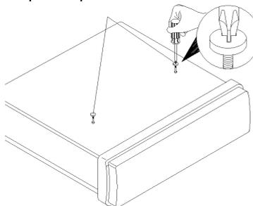
Перед началом установки выкрутите два винта, служащих для предотвращения повреждений механизма воспроизведения дисков. Не загружайте в устройство диск, если винты не были выкручены.
