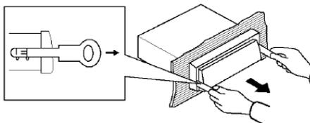
5. Вставьте до упора ключи, входящие в комплект поставки проигрывателя, в пазы на боковых поверхностях передней панели и извлеките проигрыватель из приборной панели, потянув его на себя.
