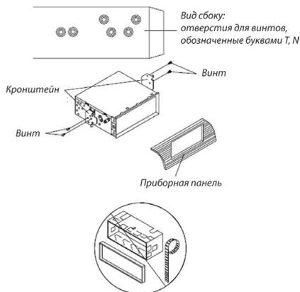
Выберите позицию, при которой винтовые отверстия кронштейнов, закрепленных в автомобиле, и винтовые отверстия приемника, отмеченные соответствующими буквами названия марки автомобиля, совпадут, и закрепите проигрыватель с каждой стороны при помощи 2-х винтов 5x5 мм.
