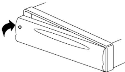
Чтобы установить переднюю панель, сначала закрепите ее правую часть. Затем прижмите левую часть передней панели к проигрывателю до щелчка.
