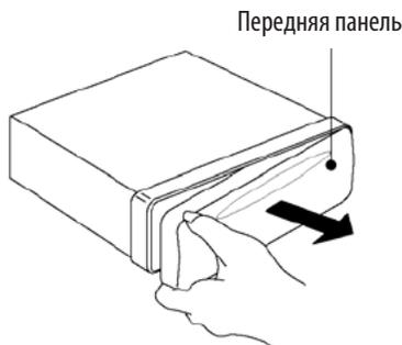
Перед тем как снять переднюю панель, выключите питание прибора. Затем нажмите кнопку снятия передней панели
