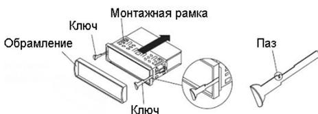
4. Вставьте монтажную раму (без корпуса проигрывателя) в отсек приборной панели и отогните «язычки» при помощи отвертки. Не все «язычки» подходят под конструкцию приборной панели конкретного автомобиля, выберите наиболее подходящие.
