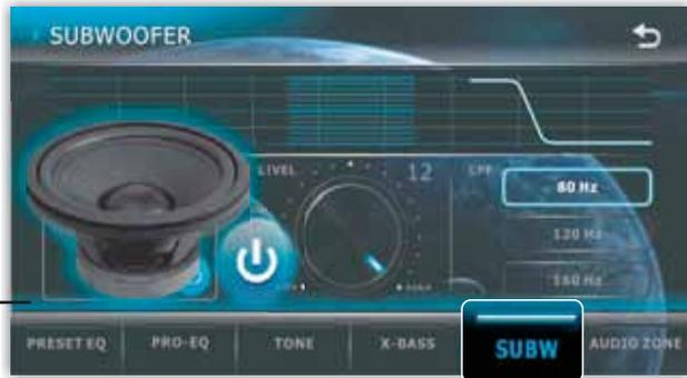
Фильтр пропускания низких частот
