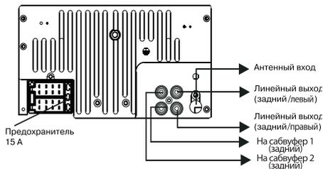
При замене перегоревшего предохранителя используйте предохранитель того же номинала.
