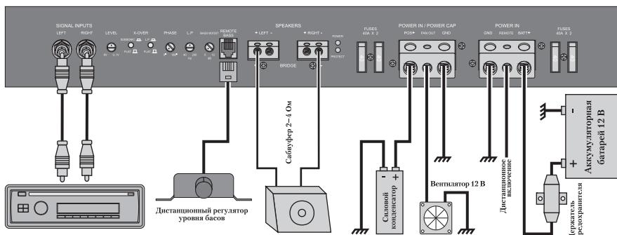
Для передачи сигнала с головного устройства на усилитель используется два отдельных кабеля RCA.
